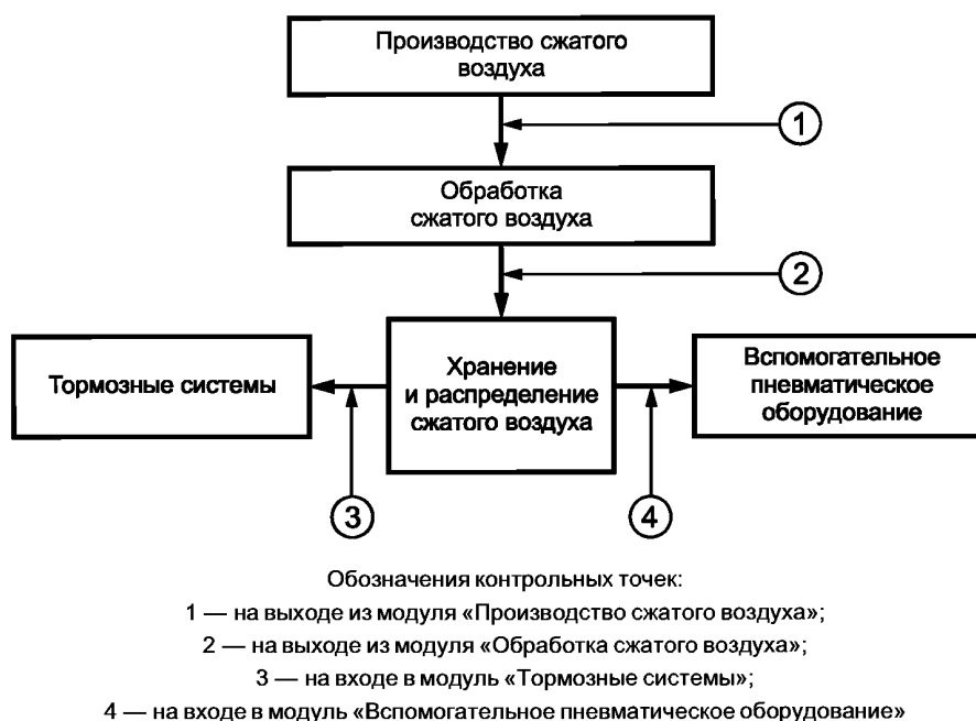
Рисунок 1 — Схема деления пневматической системы на функциональные модули и нахождения контрольных точек для определения качества сжатого воздуха
