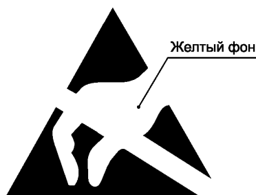
Рисунок 12 — Чувствительная к электростатическому разряду деталь или узел
