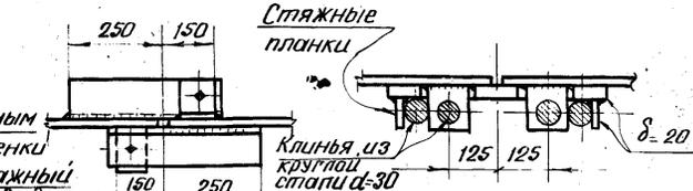
При разных толщинах стыкуемых стенок
