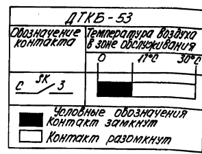
Диаграмма замыкания контактов. Регулятор температуры SK
