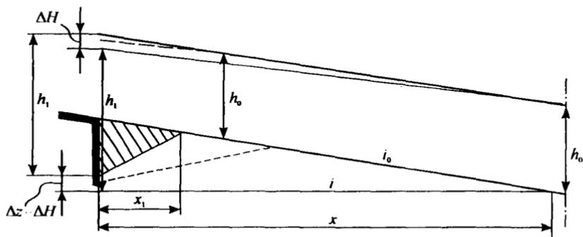
Рис. 13. Схема расчета общего размыва по приближенному методу
