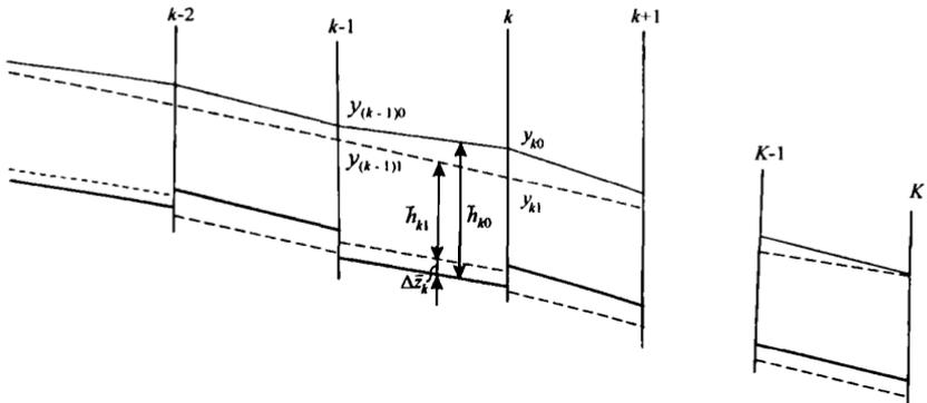
Рис.12. Схема, поясняющая расчет свободной поверхности в деформированном русле
