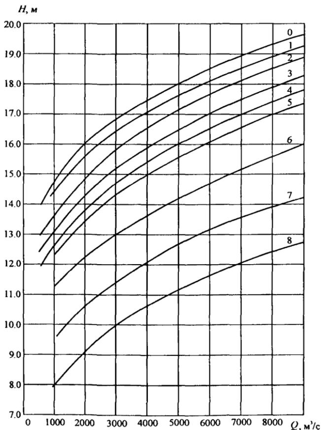
Рис. П1.2. Зависимости  $Q = f(H)$  в створах нижнего бьефа гидроузла
