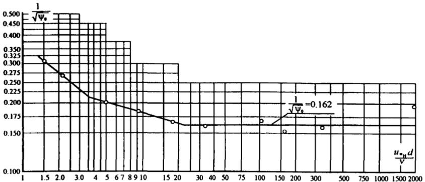
Рис. 7. График изменения коэффициента подвижности  $\frac{1}{\sqrt{\psi_0}}$  донных частиц от параметра  $u_{*n} d/\nu$  по В.С. Кнорозу
