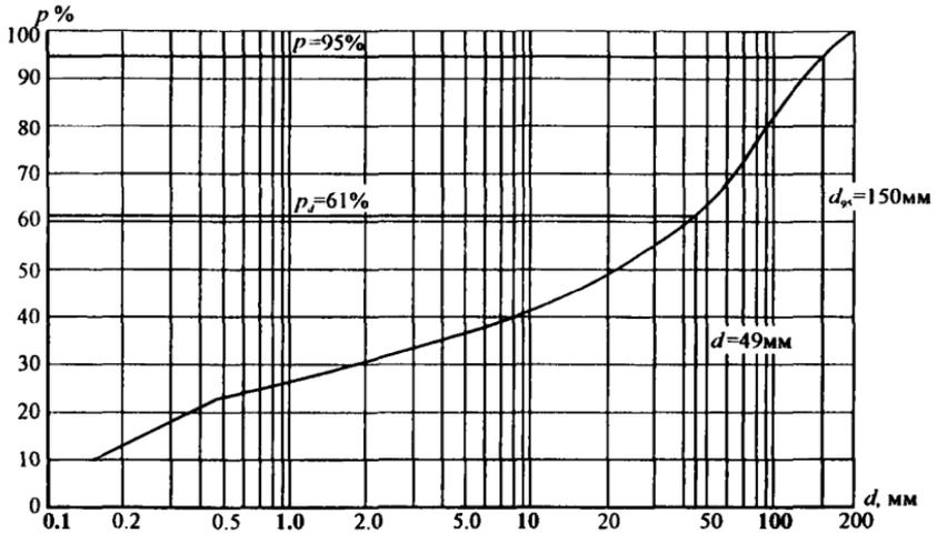
Рис. ПЗ.1. Кривая гранулометрического состава наносов
