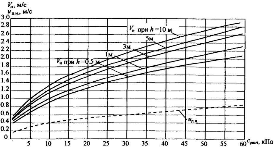
Рис. 6. Зависимость неразрывающих скоростей  $V_n$  связанных грунтов от расчетного значения сцепления  $c_{расч} = c_n / K_c$  при плотности  $\rho_s = 2650 \text{ кг/м}^3$  и коэффициенте  $m_n = 1$
