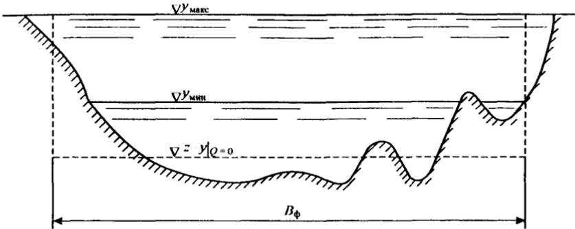
Рис. 8. Схематизация живого сечения потока
