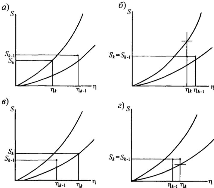
Рис. 11. Схема, поясняющая определение концентрации взвешенных наносов  $S = f(\eta)$  по данным натуральных наблюдений
