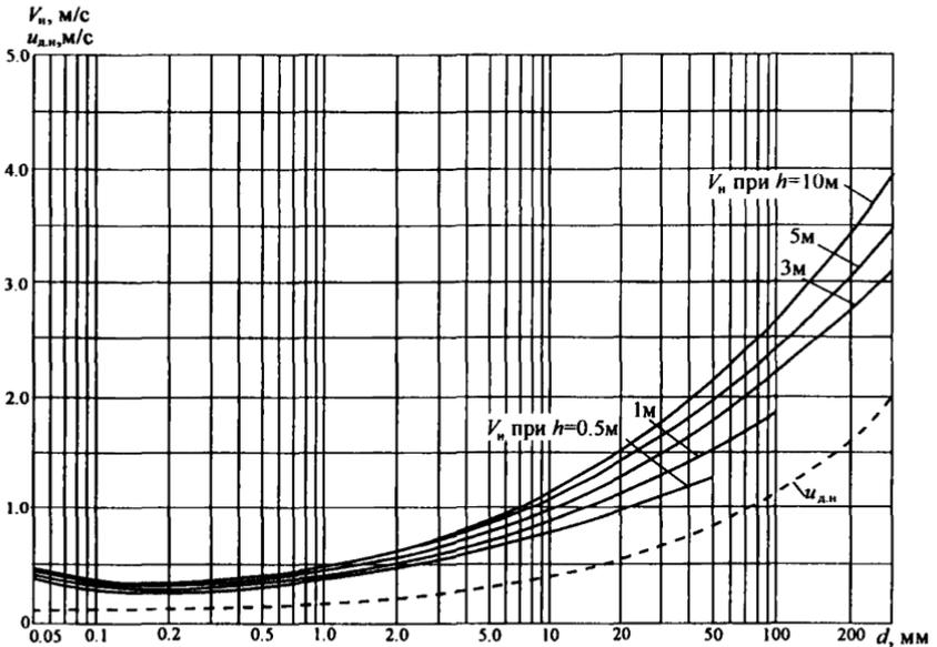
Рис.4. Зависимость неразмывающей скорости  $V_n$  несвязных грунтов от диаметра частиц  $d$  и глубины потока  $h$  (при плотности  $\rho_s = 2650 \text{ кг/м}^3$ , коэффициенте формы  $\theta = 0,73$ , коэффициенте безопасности  $K_c = 2$  и коэффициенте  $m_n = 1$ )
