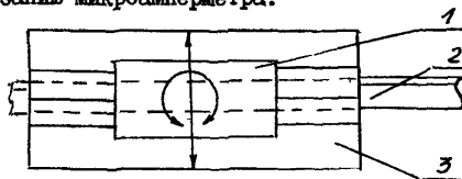
Рис.3. Установка преобразователя на поверхности прокладки
