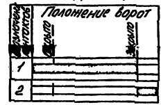
Диаграммы замыканий контактов конечных выключателей 43-SQ2, 44-SQ2
