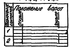
Диаграммы замыканий контактов конечных выключателей 43-SQ2, 44-SQ2
