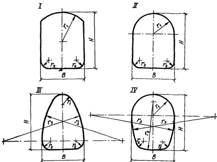
Рис 1. Поперечные сечения туннелей в свету
