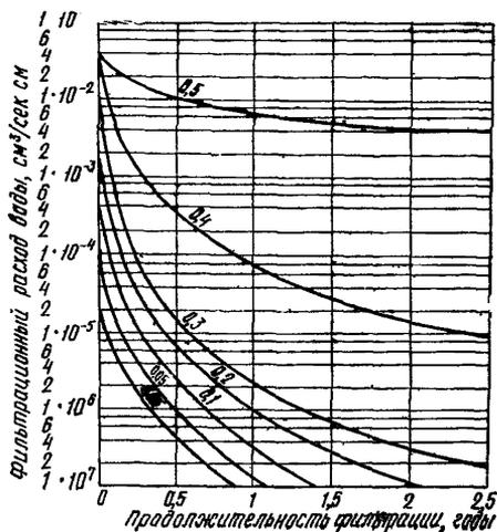
Рис. 5. Расчетные кривые самоуплотнения трещин в бетоне (цифрами у кривых обозначены величины раскрытия трещин в мм)
