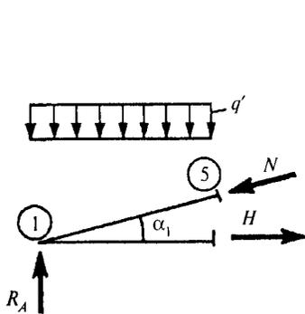
Рис. 11.4. Схема усилий в опорном узле оболочки
