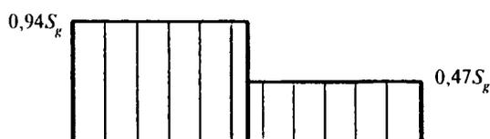
Рис. 10.7. Неравномерное (по прямоугольнику) распределение снега на покрытии
