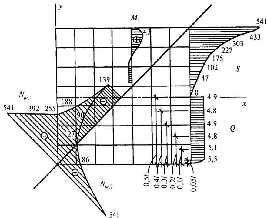
Рис. 10.5. Эпюры усилий  $M$ ,  $S$ ,  $Q$ ,  $N_{pr}$
