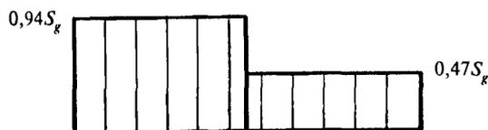
Рис. 5.5. Неравномерное (по прямоугольнику) распределение снега на покрытии
