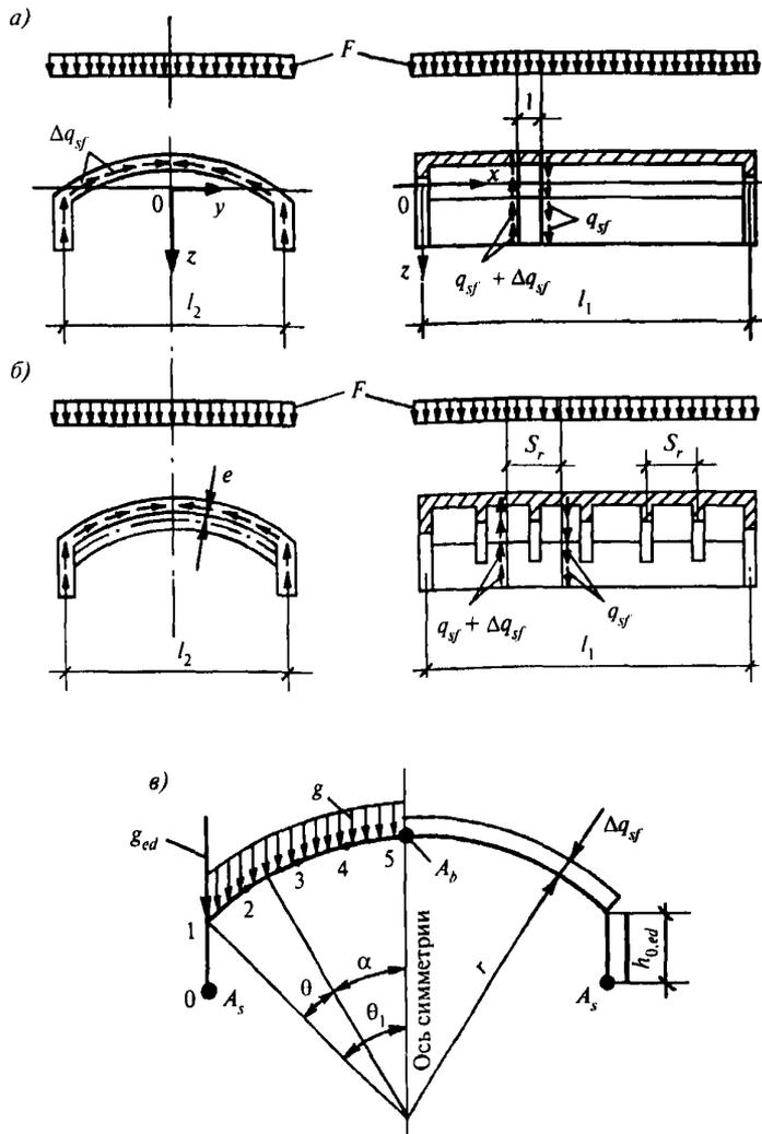
Рис. 7.7. К определению поперечных изгибающих моментов в однослойных длинных цилиндрических оболочках: *a* — в гладких; *б* — в ребристых; *в* — схема нагрузки (слева) и эпюра сдвигающих усилий (справа) в сечении, нормальном к продольной оси оболочки
