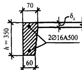
Рис. 11.3. Геометрия и армирование контурного ребра панели
