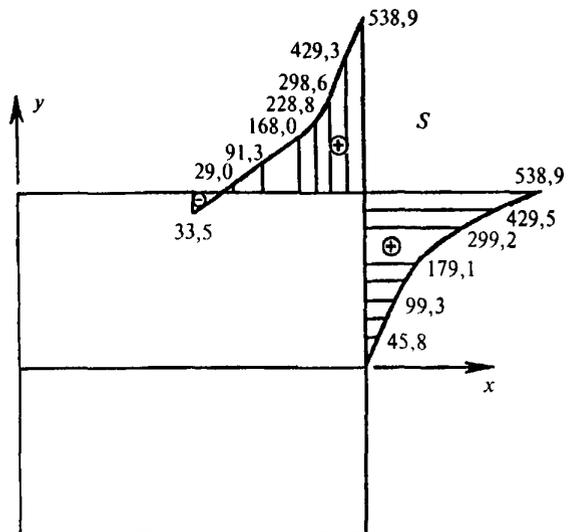
Рис. 10.9. Эпюры  $S$  для случая неравномерной снеговой нагрузки
