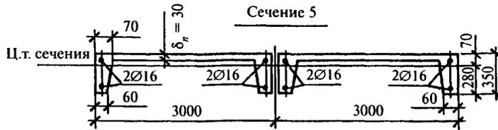
Рис. 11.9. Геометрические размеры шпренгельной системы в сечении 5
