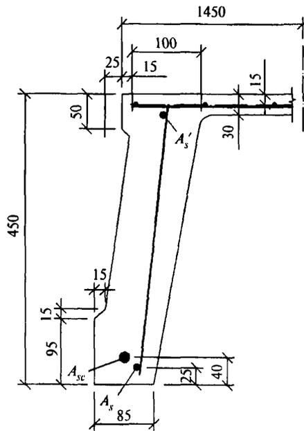
Рис. 8.5. Продольное ребро
