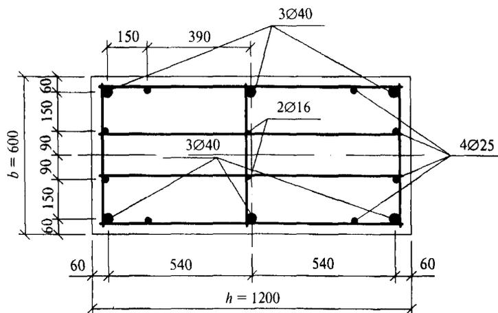
Рис. 12.3. Поперечное сечение и армирование опорного кольца
