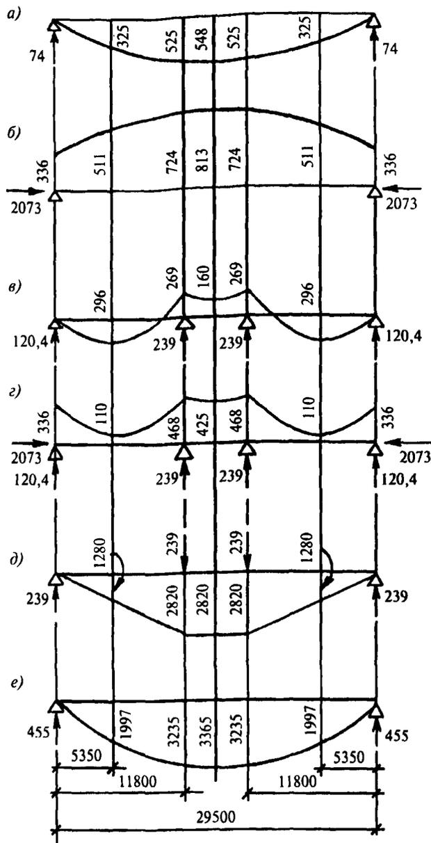
Рис. 7.5. Эпюры изгибающих моментов от нормативных нагрузок, действующих в бортовой балке до замоноличивания (эпюры а–с) и в замоноличенной оболочке (эпюры д, е):
