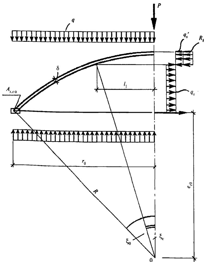
Рис. 9.8. К расчету купола по «балочной» схеме
