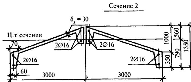
Рис. 11.7. Геометрические размеры шпренгельной системы в сечении 2
