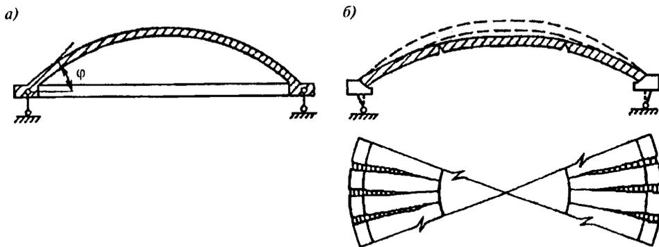
Рис. 9.7. К расчету купола по предельному равновесию:
