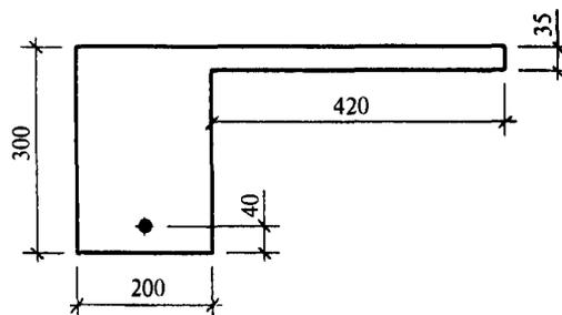
Рис. 10.13. Поперечное сечение плиты (на два ребра)
