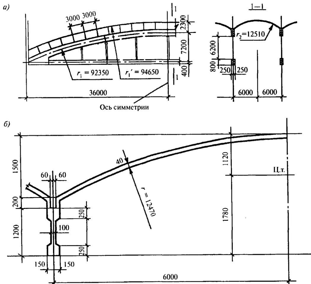
Рис. 5.1. Схема многоволнового свода пролетом 72 м:
