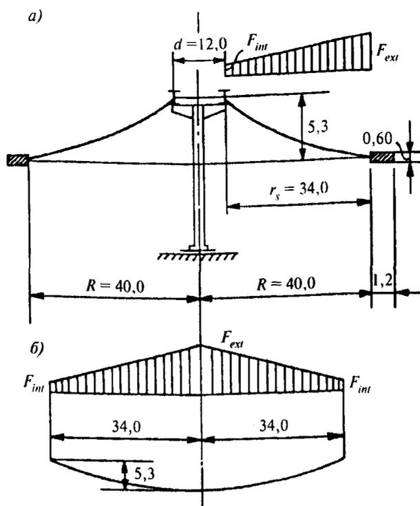
Рис. 12.1. К расчету кругового шатрового покрытия:
