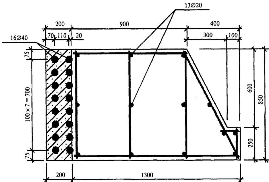
Рис. 9.5. Поперечное сечение и армирование опорного кольца купола
