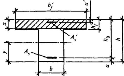
Рис. 11.10. Приведенное сечение таврового профиля для сечения 5 шпренгельной системы
