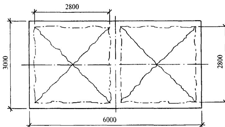
Рис. 10.14. Схема разрушения полки ребристых панелей
