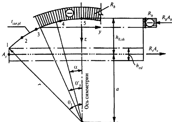
Приняв  $\sin\theta'_b \approx \theta'_b$ , найдем выражение для половины центрального угла, охватывающего участок сжатой зоны дуги поперечного сечения оболочки
