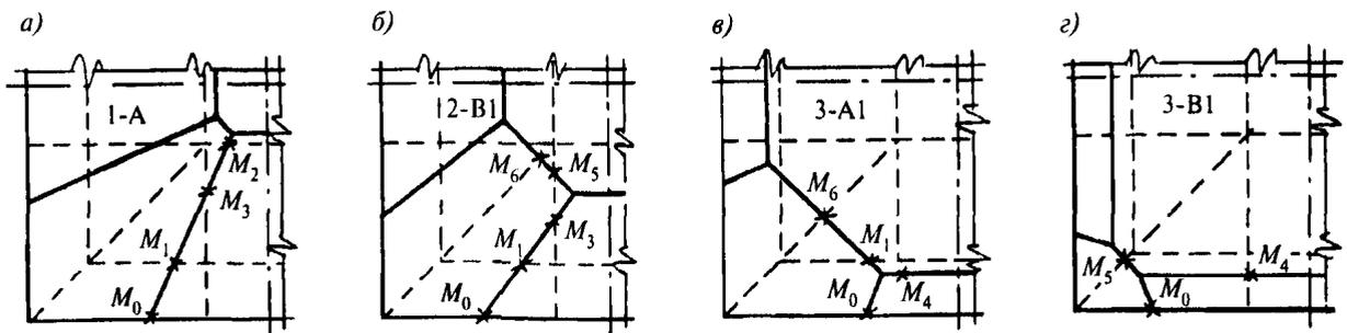
Рис. 15.3. Некоторые расчетные случаи вычисления работы внутренних сил
