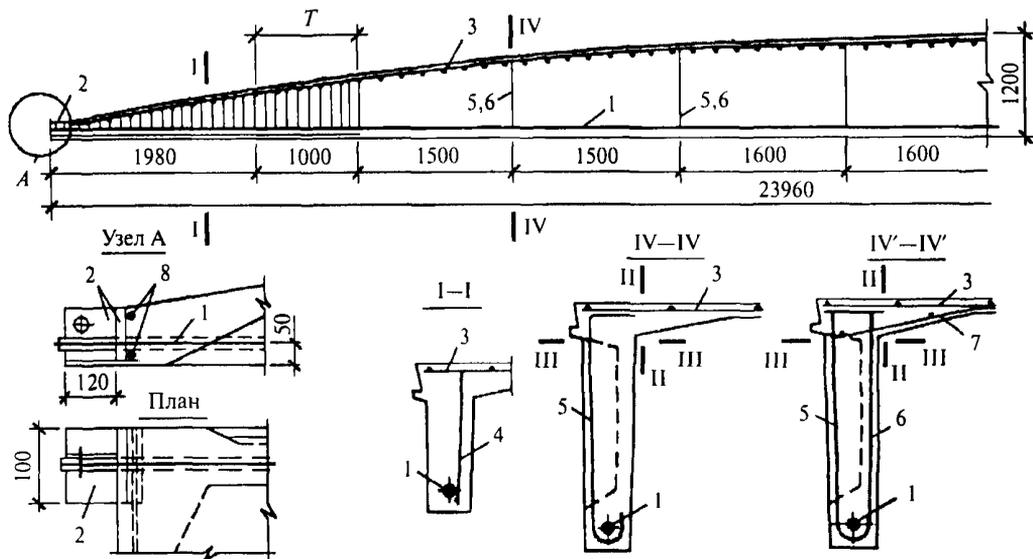
Рис. 13.5. Армирование панели-оболочки КЖС размером 3×18 м:
