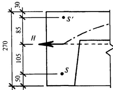
Рис. 14.2. Положение арматуры и плоскости действия шатрового распора по высоте сечения ребра
