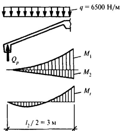
Рис. 6.5. Эпюра расчетного изгибающего момента  $M_l$
