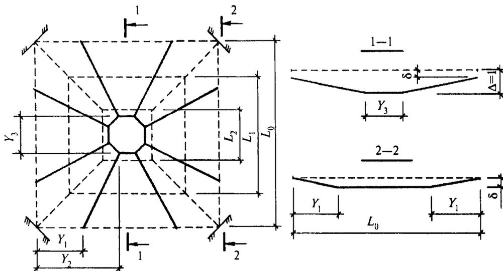
Рис. 15.2. Девятизвенная схема излома
