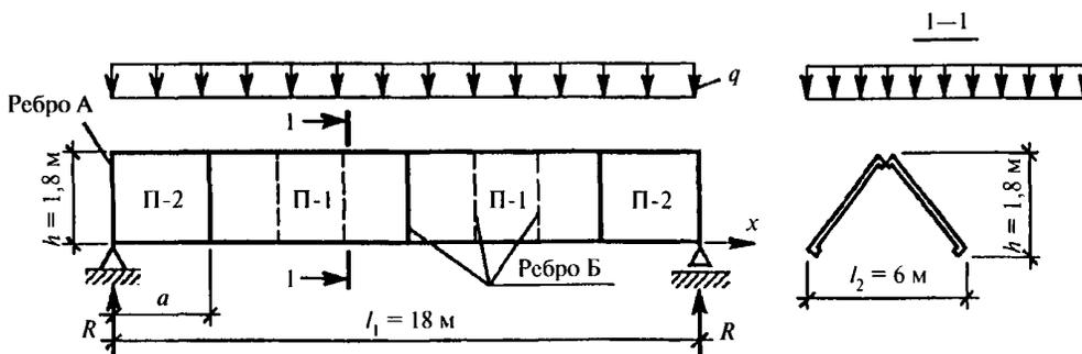
Рис. 6.1. Конструктивная схема складки из ребристых плит
