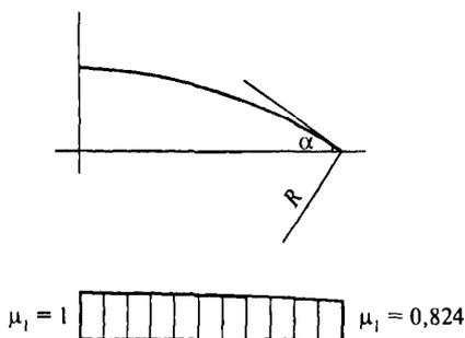
Рис. 10.3. К расчету покрытия на симметричную снеговую нагрузку
