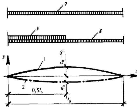
Рис. 13.6. Расчетная схема панели-оболочки КЖС:
