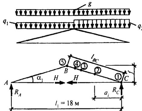
Рис. 11.11. Расчетная схема оболочки на одностороннюю снеговую нагрузку
