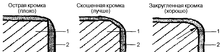
Рис. 2.1. Обработка острых кромок. 1 – Металл; 2 – покрытие
