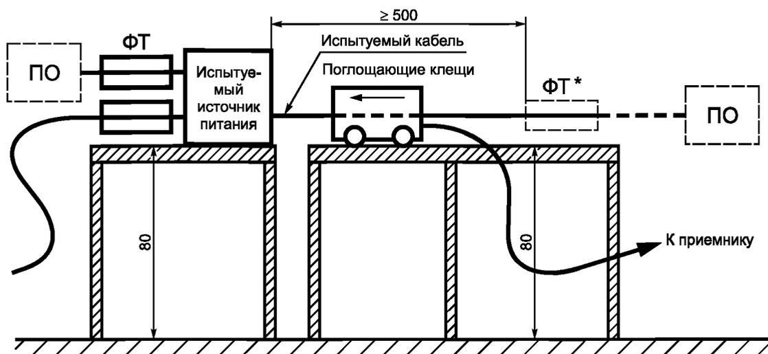
ПО — подключаемое оборудование; ФТ — ферритовая трубка, аналогичная применяемой в поглощающих клещах; ФТ\* — дополнительная ферритовая трубка, аналогичная применяемой в поглощающих клещах, для дополнительной развязки
