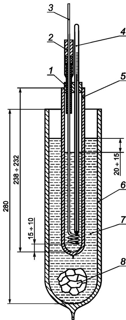
1 — пробка; 2 — втулка, защищающая от влаги; 3 — мешалка; 4 — термометр; 5 — сосуд для образца с двойными стенками: наружная стенка наружным диаметром  $(30 \pm 0,7)$  мм и толщиной стенки  $(1,9 \pm 0,3)$  мм; внутренняя стенка внутренним диаметром  $(18,7 \pm 1,1)$  мм и толщиной стенки  $(1,65 \pm 0,35)$  мм; 6 — вакуумная колба (сосуд Дьюара), несеребряная внутренним диаметром не менее 70 мм; 7 — хладагент; 8 — твердая углекислота
