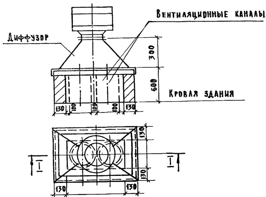
Рис. 7. Установка дефлектора на вытяжной шахте
