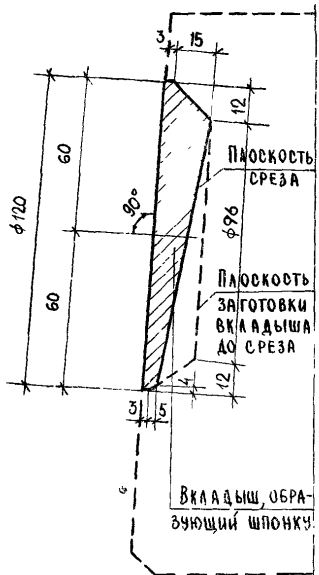
ДЕТАЛЬ ЗАГОТОВКИ ВКЛАДЫША, ОБРАЗУЮЩЕГО ШПОНКУ
