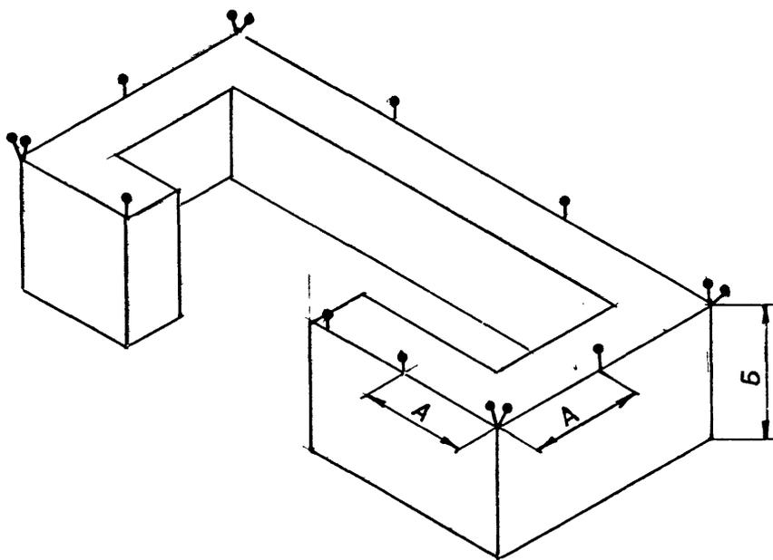
Рис. I. Примеры расположения огней светового ограждения
