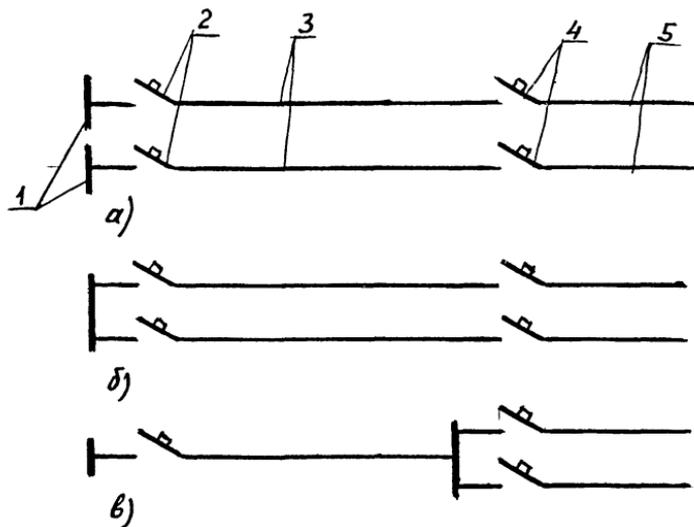
Рис 2 Схемы питания светового ограждения
