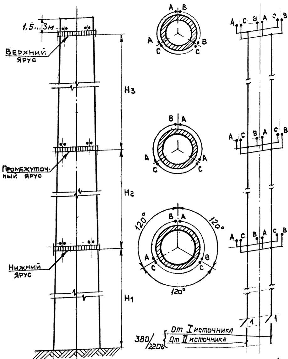
Рис. 3. Размещение и схема питания заградительных огней на трубе.
