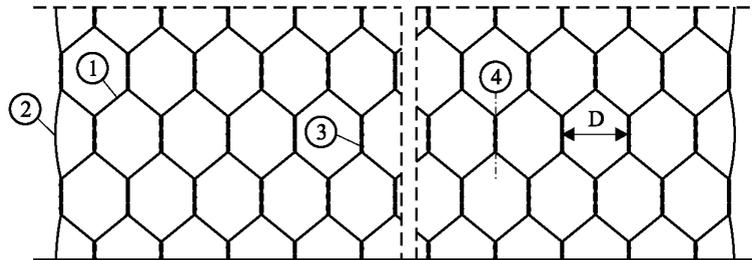
1. Металлическая проволока. 2. Проволока кромки.
