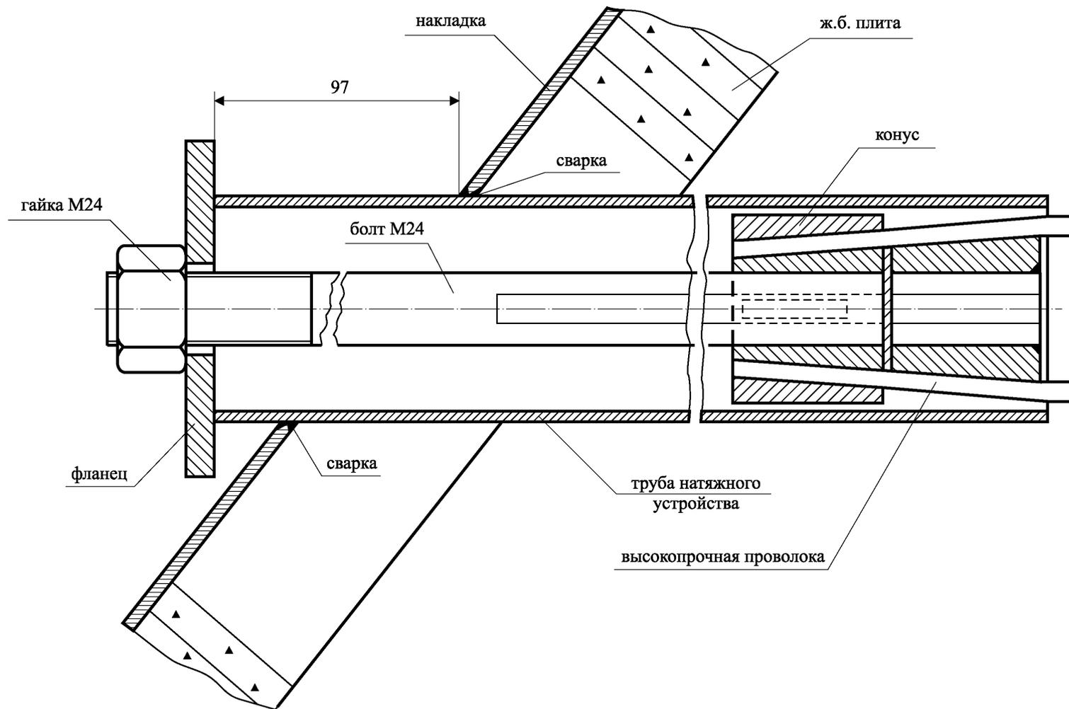
Детали натяжного устройства стягивающего элемента
