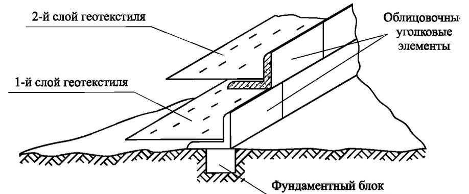
Конструкция сопряжения фундамента с облицовочной стеной
