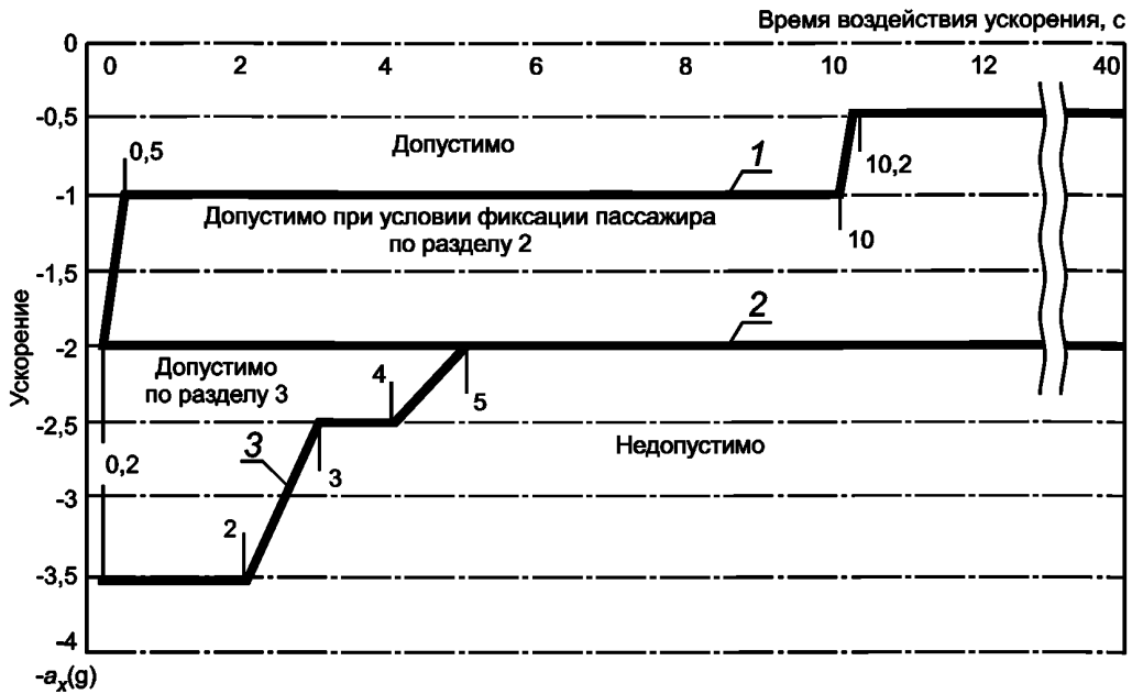
Рисунок А.5 — Длительность предельно допустимых линейных ускорений «грудь — спина» -a_x(g) для пассажира аттракциона, зафиксированного в кресле в позе «сидя» (кривые 1, 2) или в позе «лежа» (кривая 3), при единичном воздействии импульса
