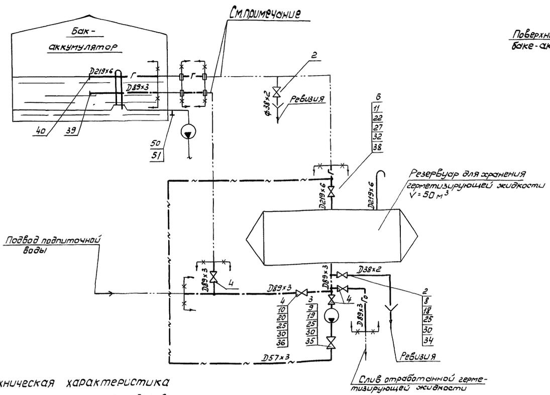
Схема работы устройства загрузки и выгрузки герметизирующей жидкости
