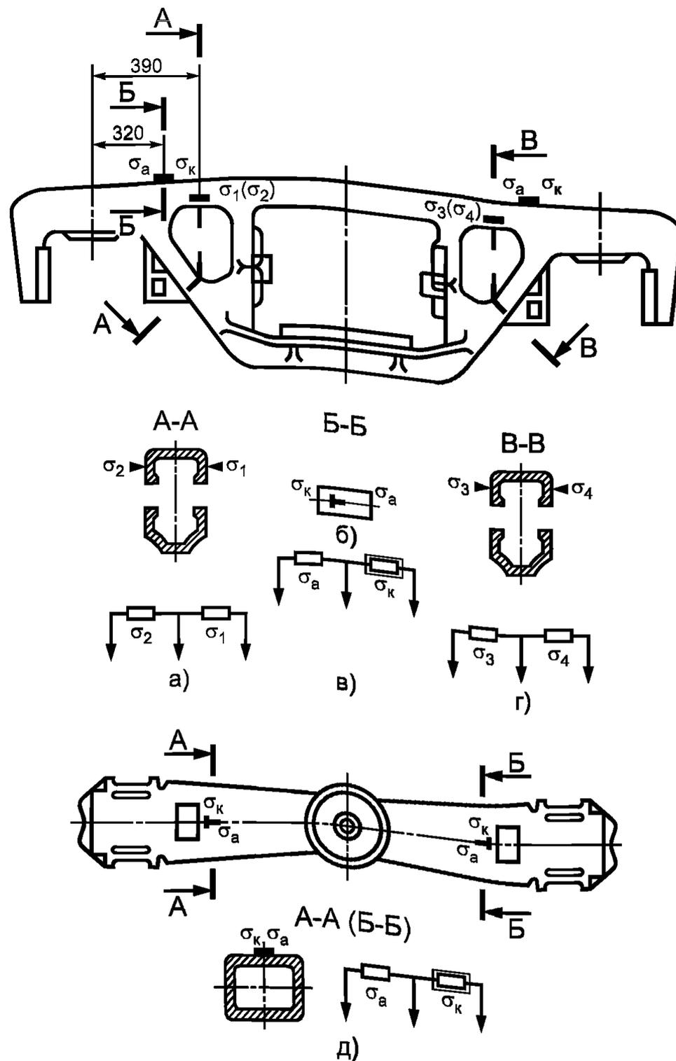
а) схема соединения датчиков в сечении А—А; б) схема наклейки датчиков в сечении Б—Б; в) схема соединения датчиков в сечении Б—Б; г) схема соединения датчиков в сечении В—В; д) схема соединения датчиков в сечении А—А (Б—Б)
