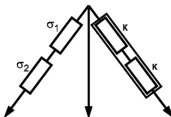
$\sigma_1$ ,  $\sigma_2$  — активные тензометрические датчики; к — композиционные тензометрические датчики
