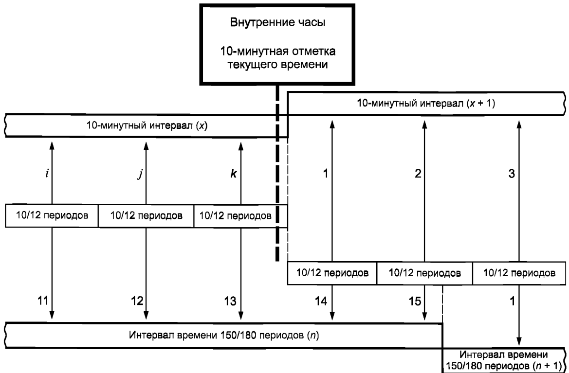
Рисунок 3 — Синхронизация объединенных интервалов для класса S: измерение показателей КЭ, для которых пропуски недопустимы
