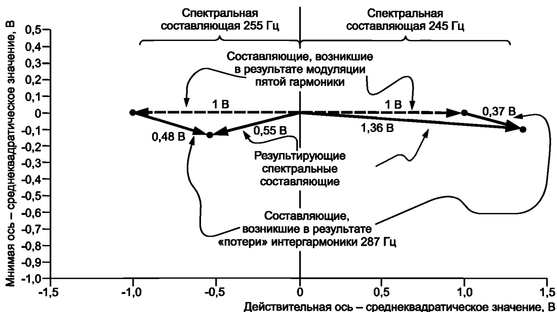
Рисунок С.7 — Векторы спектральных составляющих на частотах 245 и 255 Гц
