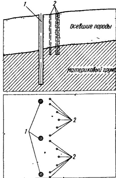
Рис.7. Свайное ограждение из однорядных набивных свай и систем грутонабивных свай
