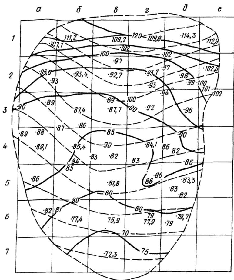
Рис 55. Горизонтали топоповерхности и изолинии проектной поверхности оползня
