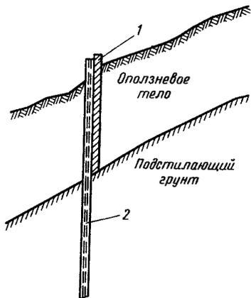
Рис. 49. Схема конструкции свайно-панельной удерживающей стены
