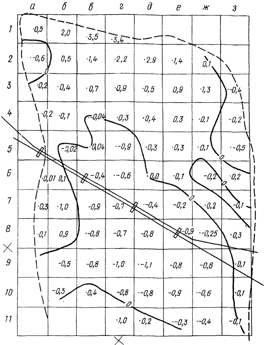
Рис.57. Оконтурирование зон пассивного оползневое давления на оползневом участке
