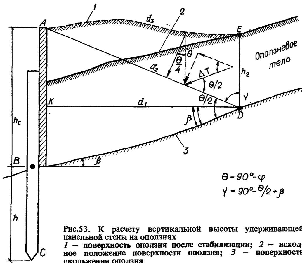
Рис.53. К расчету вертикальной высоты удерживающей панельной стены на оползнях
