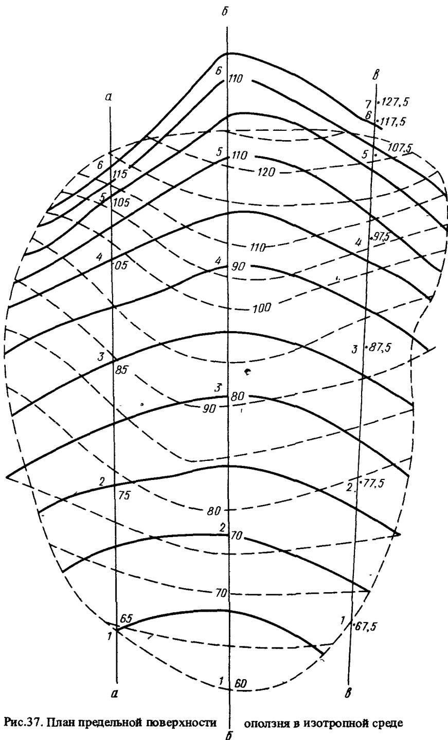
Рис.37. План предельной поверхности оползня в изотропной среде
