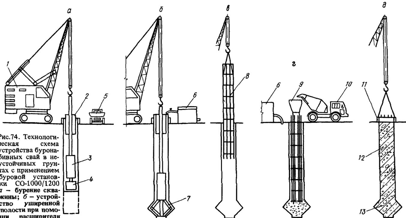
Рис. 74. Технологическая схема устройства буронабивных свай в неустойчивых грунтах с применением буровой установки СО-1000/1200
