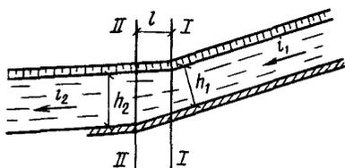
Рис.62. Схема определения сопряжения уклонов
