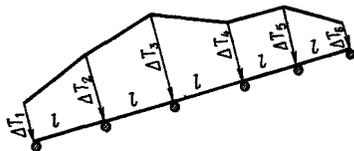
Рис. 50. Эпюра оползневой массы на свайно-панельную удерживающую стену
