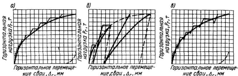
Рис. 79. Графики зависимости горизонтального перемещения сваи от вида нагрузки
