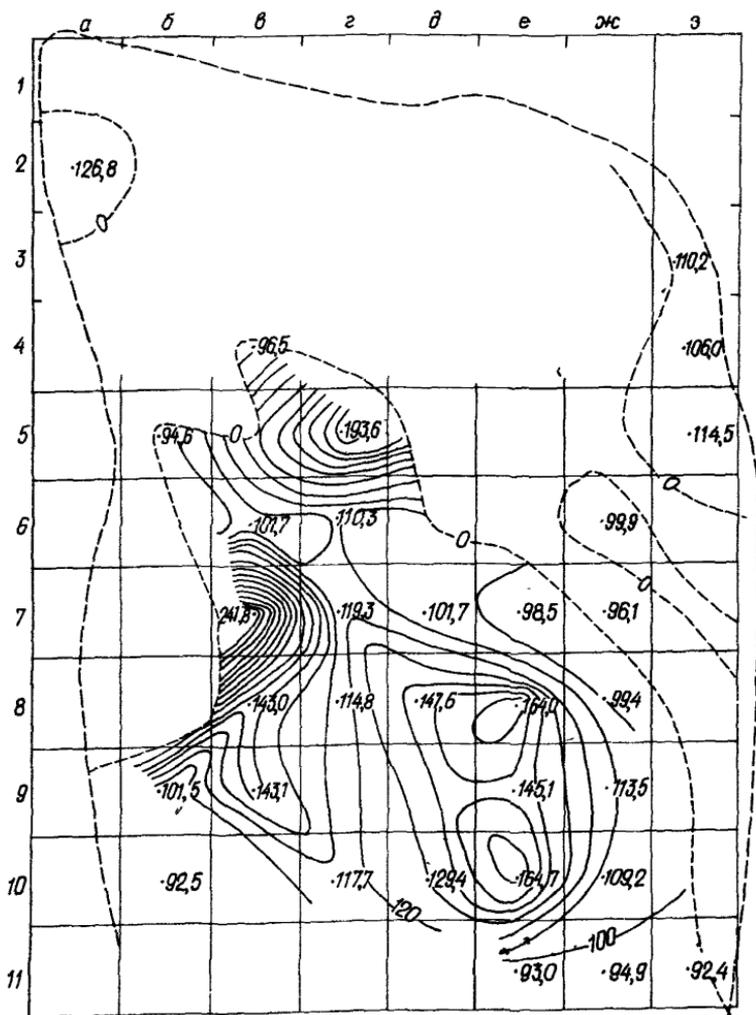
Рис.59. План устойчивой проектной поверхности оползня
