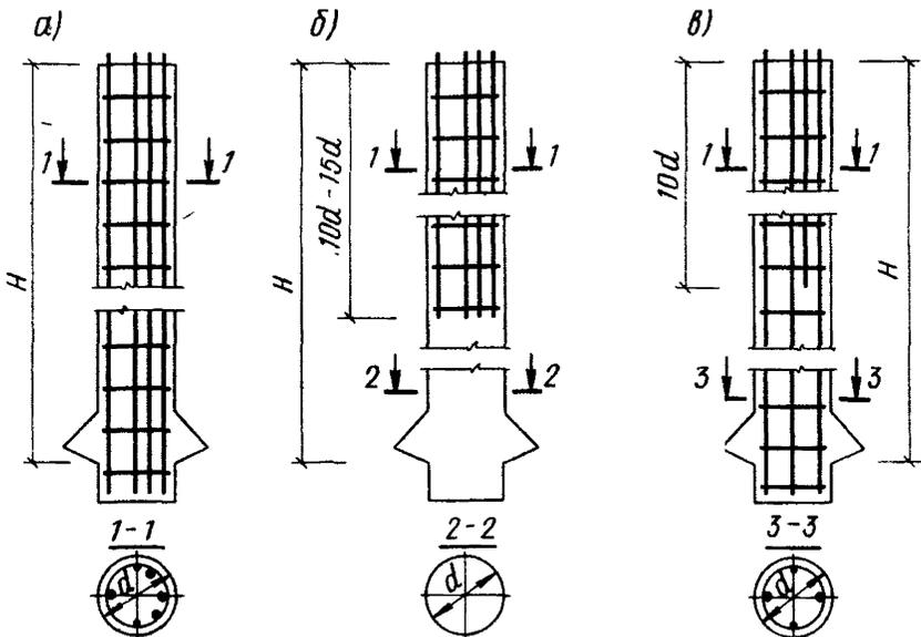
Рис.18. Бутонабивные сваи с сосредоточенным несимметричным армированием
