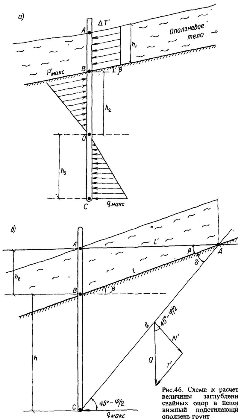
Рис.46. Схема к расчету величины заглубления свайных опор в неподвижный подстилающий оползень грунт
