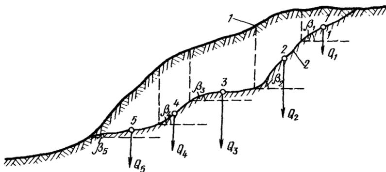
Рис.26. Схема к расчету оползневой нагрузки по методу Шахунянца:
