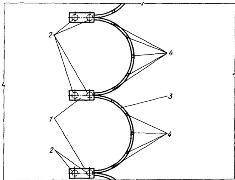
Рис.13. Удерживающие противоползневые сооружения из буронабивных свай с арочным заполнением между ними
