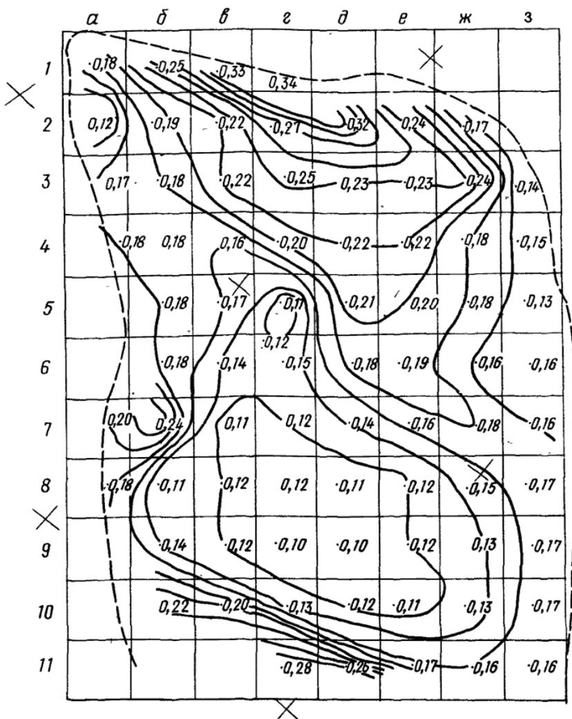
Рис.33. План изоуклонов поверхности скольжения оползня
