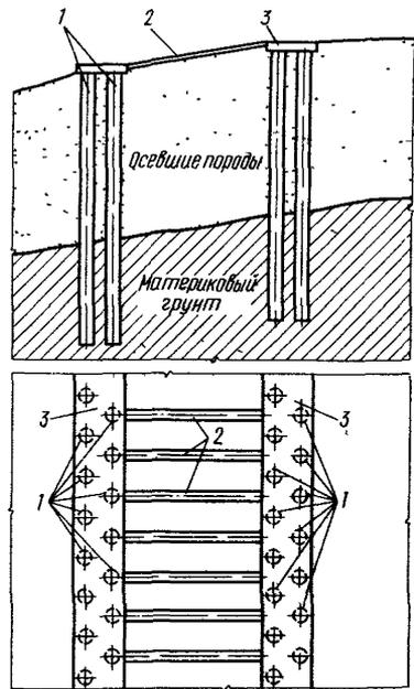
Рис.9. Двухъярусное свайное ограждение из двухрядных буронабивных свай, объединенных ростверками и анкерами
