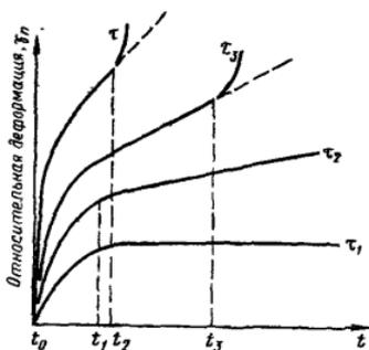
Рис. 22. График испытаний грунтов на ползучесть
