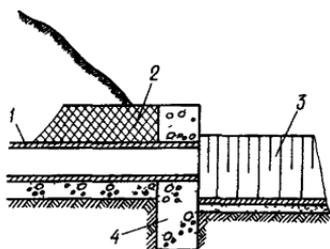
Рис.65. Оголовки дрен портального типа
