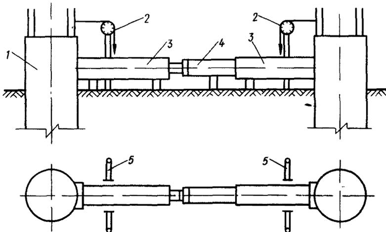
Рис. 76. Схема одновременного испытания двух свай
