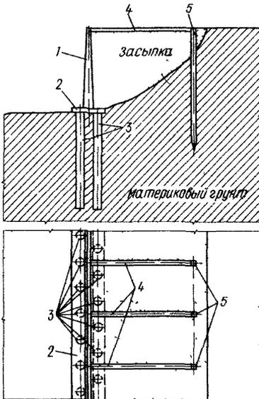
Рис.3. Подпорные стенки, возводимые на двухрядных буронабивных сваях, объединенных ростверком
