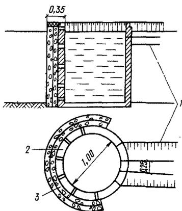
Рис.63. Схема устройства каптажей в виде колодца
