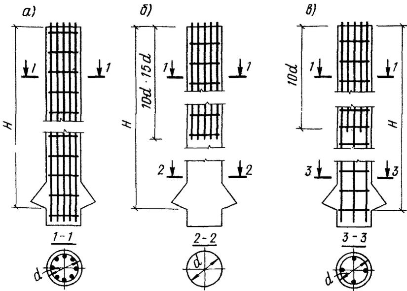
Рис.17. Бутонабивные сваи с равномерно распределенным армированием
