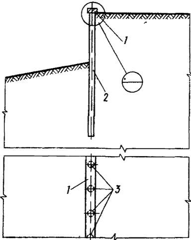
Рис.4. Однорядное свайное ограждение из буронабивных свай, объединенных ростверком
