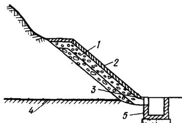
Рис.64. Схема устройства каптажей в виде наклонного обратного фильтра
