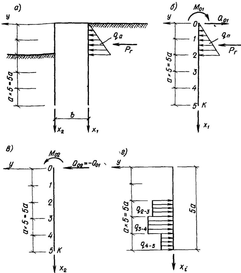
Рис.67. Подпорное сооружение из буронабивных свай
