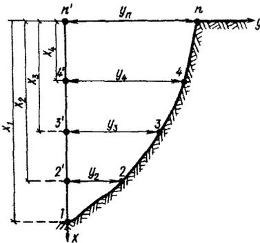
Рис. 28. Схема построения равноустойчивых откосов по безразмерным координатам В.В. Соколовского
