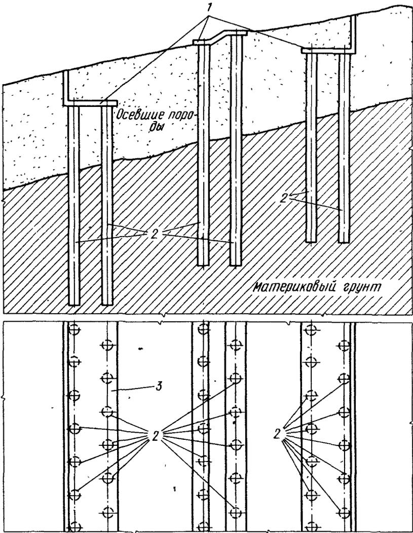
Рис.14. Удерживающие противооползневые сооружения из отдельных свайных полей
