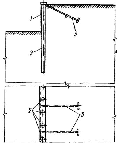
Рис.5. Однорядные подпорные стенки с буронабивными сваями с ростверком и анкерами
