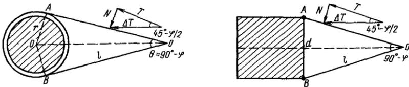
Рис.45. Схема обтекания оползнем одиночной свайной опоры
