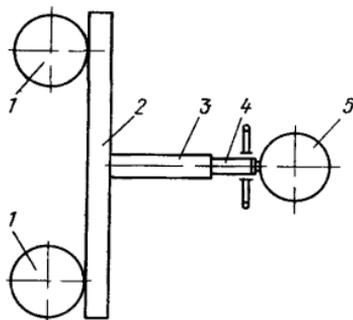
Рис. 78. Схема испытания сваи с упором в две соседние
