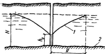
Рис. 66. Схема к определению дебита воды одиночного колодца
