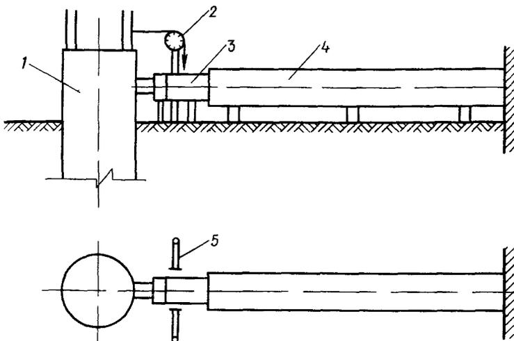
Рис. 75. Схема испытания одной сваи на горизонтальную нагрузку
