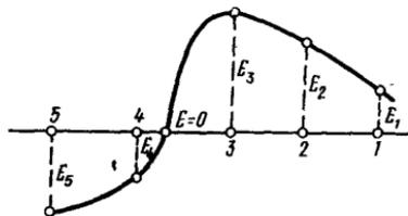
Рис.27. Эпюра оползневой нагрузки по методу Шахунянца
