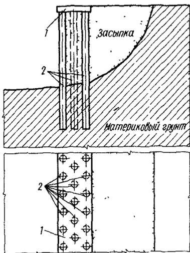
Рис.11. Подпорные стенки из трехрядных буронабивных свай, объединенных ростверком
