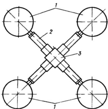
Рис. 77. Схема одновременного испытания четырех свай
