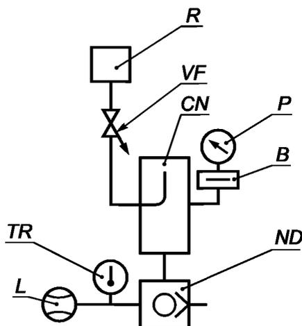
*CN* — измерительная камера; *ND* — испытуемый насос; *P* — вакуумметр; *B* — охлаждаемая ловушка; *VF* — клапан-напекатель; *R* — устройство для измерения потока; *L* — измеритель расхода воды; *TR* — датчик измерения температуры
