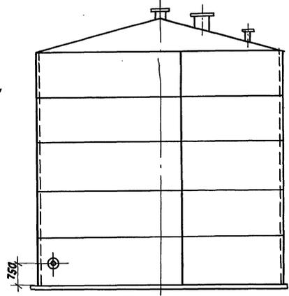
1. Место установки ТЕРМОПРЕОБРАЗОВАТЕЛЯ ЭЛЕКТРИЧЕСКОГО НА ПЯТРУБКЕ  $\text{Dy} 100$ . Способ установки см. лист 4
