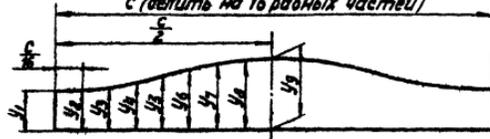
Схема раскроя трубы на секторы
