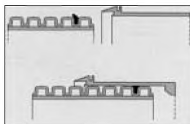
Направление установки раструба
