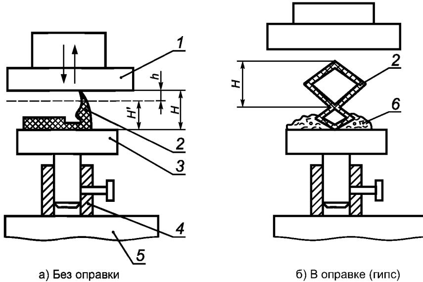
1 — верхняя подвижная плита; 2 — образец уплотнителя; 3 — опорная плита; 4 — втулка со стопорным болтом; 5 — рабочий стол; 6 — оправка;  $H$  — высота уплотнителя в свободном состоянии;  $H'$  — высота уплотнителя в сжатом состоянии;  $h$  — размер сжатия уплотнителя
