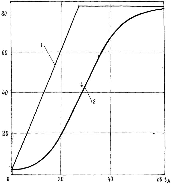
Рис.4. Изменение давления газа (P) во времени (t) в начале (1) и конце (2) заполняемого газопровода
