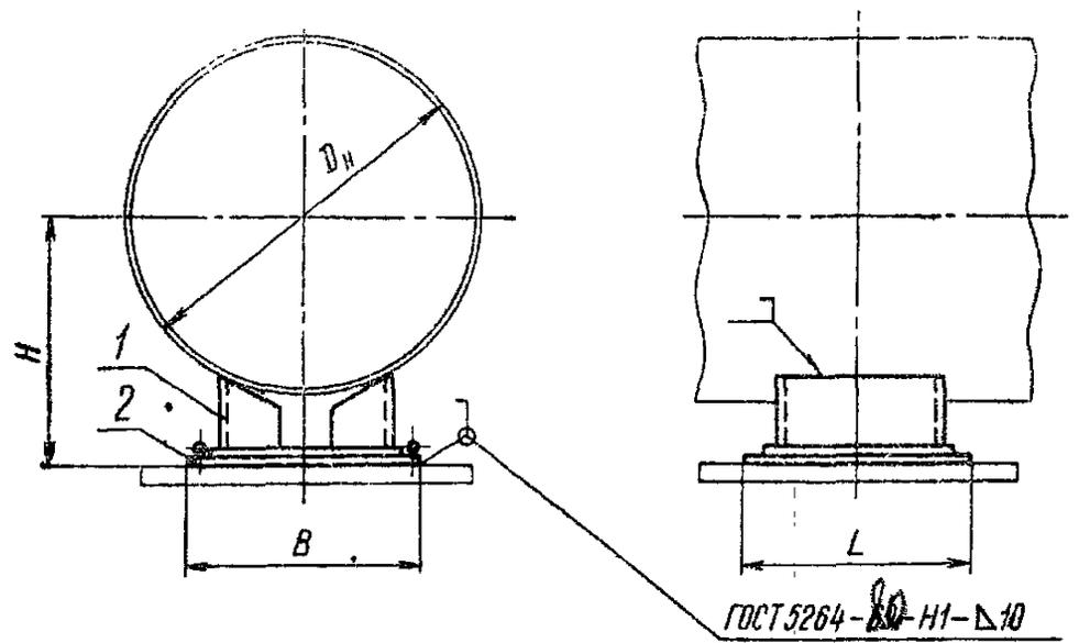
1 — опора приварная; 2 — плита направляющая
