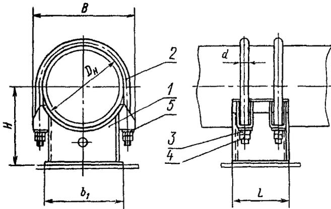
1 — корпус 2 — хомут 3 — гайка 4 — гайка 5 — шайба
