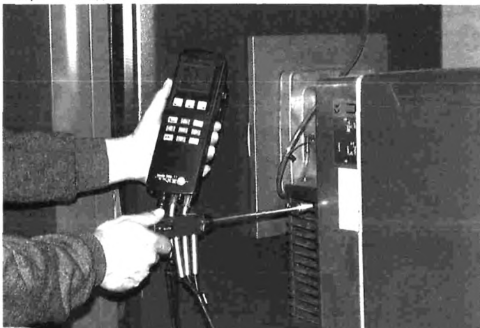
Рис. 12: Измерение температуры воздуха подающегося на горение
