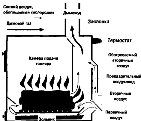
Рис. 6: Простая колосниковая печь
