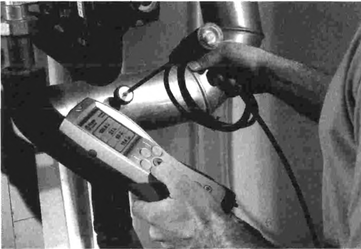
Рис. 13: Определение потери тепла с дымовыми газами
