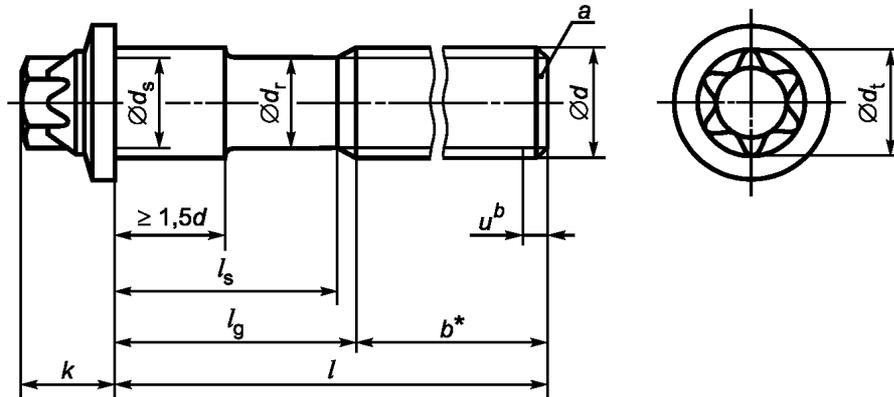
Болты длиной  $\geq 10d$  должны иметь полный цилиндрический подголовок
