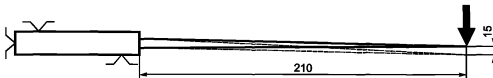
Рисунок 1 — Схема проведения испытания на прочность и упругость охотничьих тесаков
