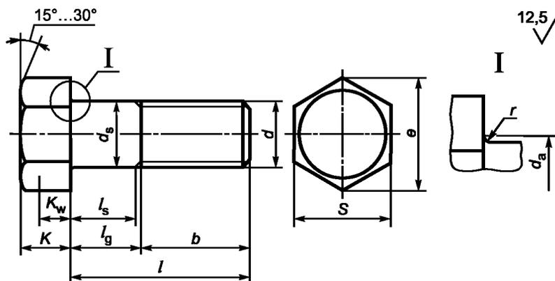
Рисунок 1 — Конструктивное исполнение тела болта 1 (основное исполнение)
