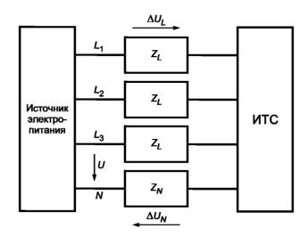
U — напряжение «фаза — нейтраль» источника электропитания;  $Z_{L,N}$  — полное сопротивление проводников и устройств измерения тока; ИТС — испытуемое ТС;  $\Delta$   $U_L$ ,  $\Delta$   $U_N$  — падение напряжения на полном сопротивлении  $Z_L$  и  $Z_N$ ;  $L_1, L_2, L_3$  — фаз- ные проводники; N — нейтральный проводник
