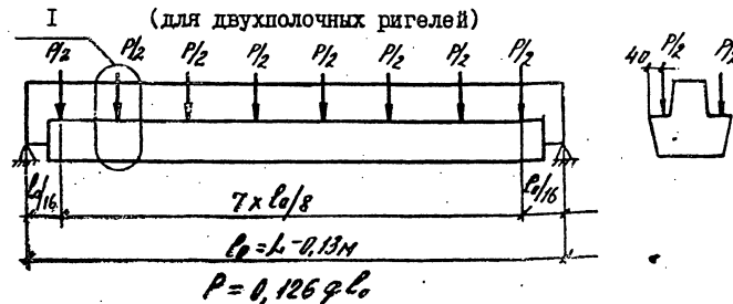
Схема №3. Опирания и загрузки ригеля для испытаний перед началом массового изготовления конструкций или внесении конструктивных изменений, или при изменении технологии изготовления, вида и качества применяемых материалов.
