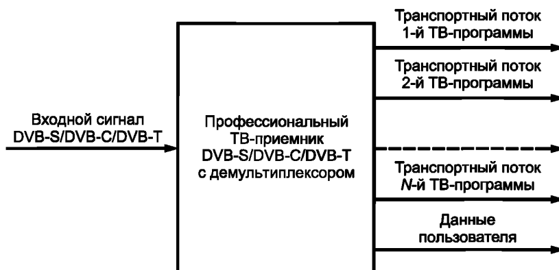
Рисунок 5 — Вывод данных пользователя с помощью профессионального ТВ-приемника DVB-S/DVB-C/DVB-T с демультимплексором
