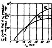
**Рис.** Зависимость постоянной скорости образования ( $\dot{C_0}$ ) радиоизотопов  $^{13}$ N и  $^{15}$ O от энергии электронов (вольфрамовая мишень)
