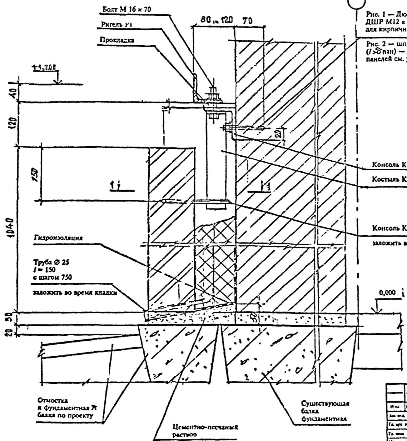
Рис. 1 — Дюбель ДШР М12 x 110 — для кирпичной стены
