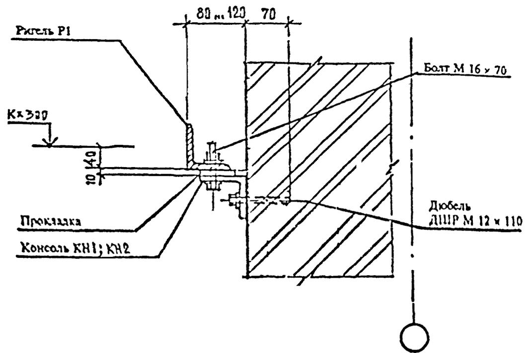
ТС26 Рис 2. Для стен из лег-кобетонных панелей
