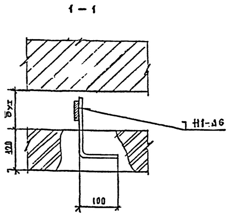
1. В случае кирпичной кладки место установки дюбеля должно располагаться по возможности по центру грани кирпича. Диаметр отверстия в кладке под дюбель ДШР М12 x 110 должно быть Ø 12,3 мм.
