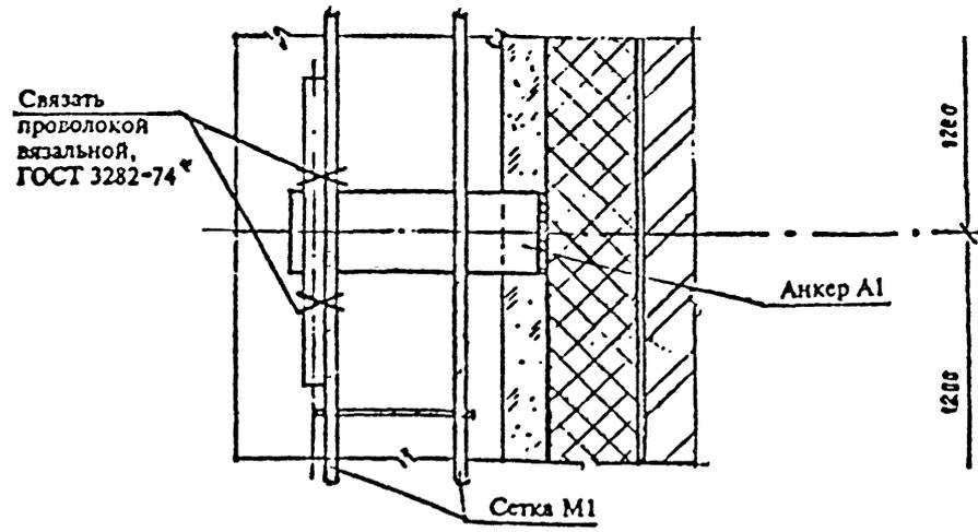
1. Крепление по рис. 2 допускается при отсутствии специальных анкеров (рис.1) в зданиях высотой до 10 м.
