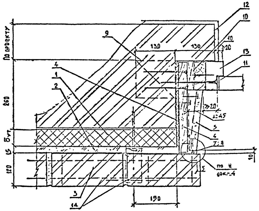
**ВД4** Горизонтальное сопряжение дверей и стены с защитным слоем из штукатурки
