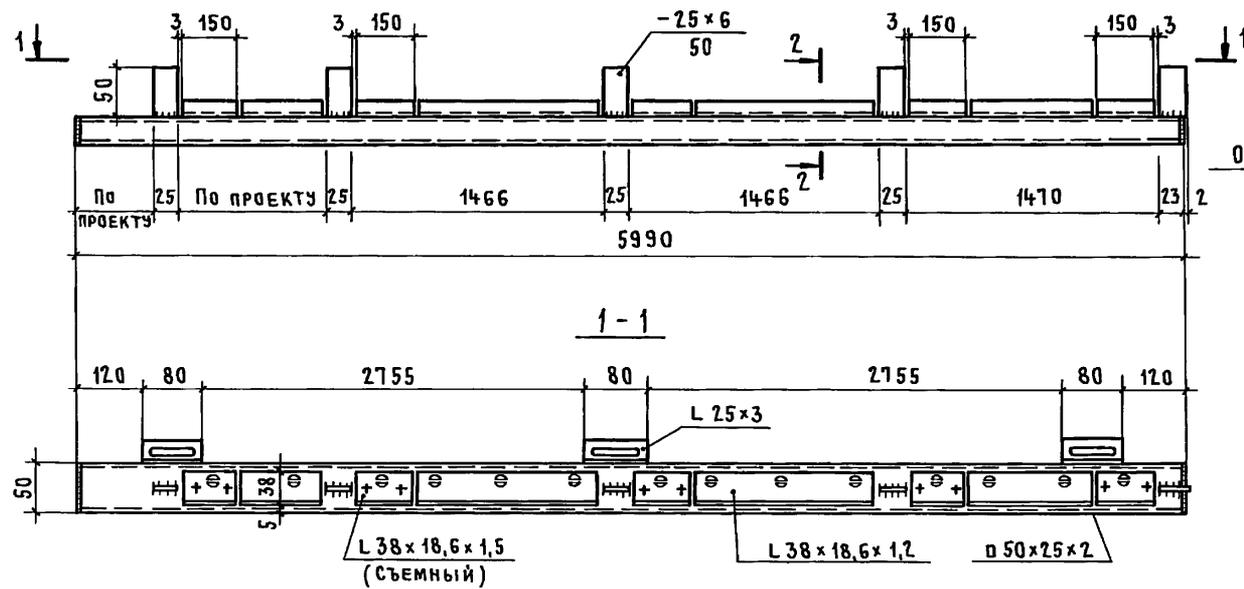
ВЕРТИКАЛЬНЫЙ ЭЛЕМЕНТ КАРКАСА „а“
