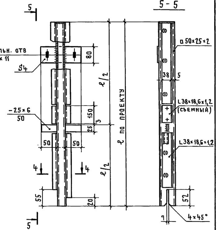
Горизонтальный элемент каркаса „а“
