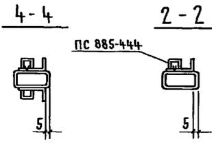
Вырезы в горизонтальных и вертикальных элементах каркаса (для опирания на столики) должны быть сделаны со стороны внутреннего шва трубы
