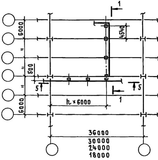
СХЕМА РАСПОЛОЖЕНИЯ ПРИ ШАГЕ ФЕРМ 12 м
