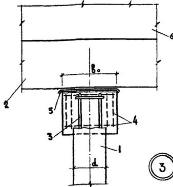
① - ЖЕСТКАЯ ЗАДЕЛКА; ② - ШАРНИРНОЕ СОПРЯЖЕНИЕ;
