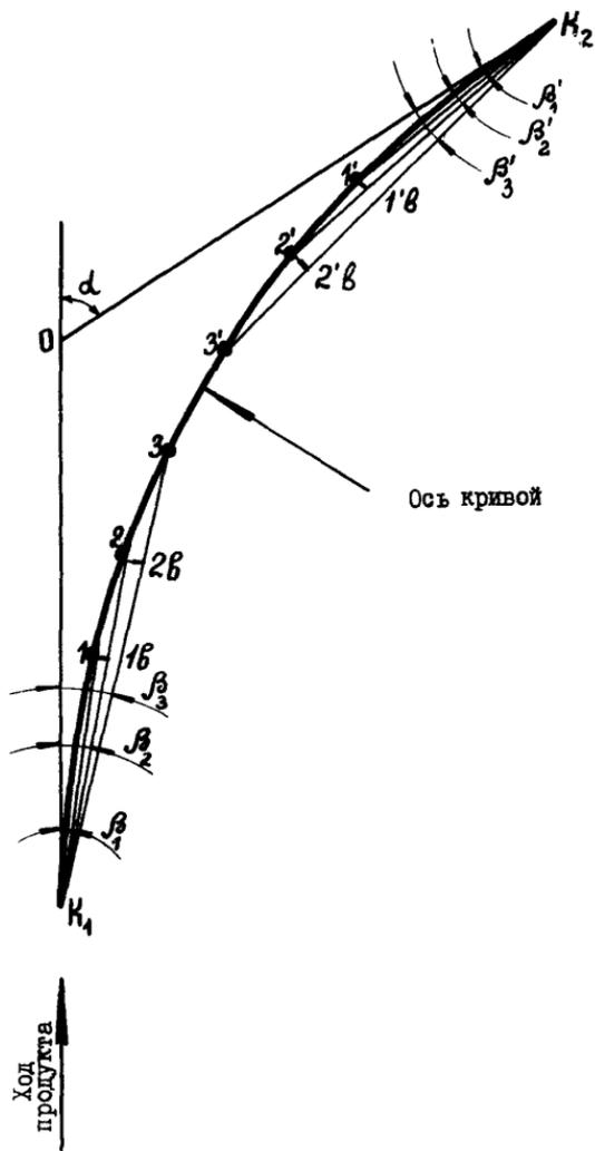
Рис.7. Основные элементы кривой поворота, разбиваемой способом хорд
