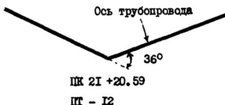
Рис.5. Основные параметры угла поворота:
