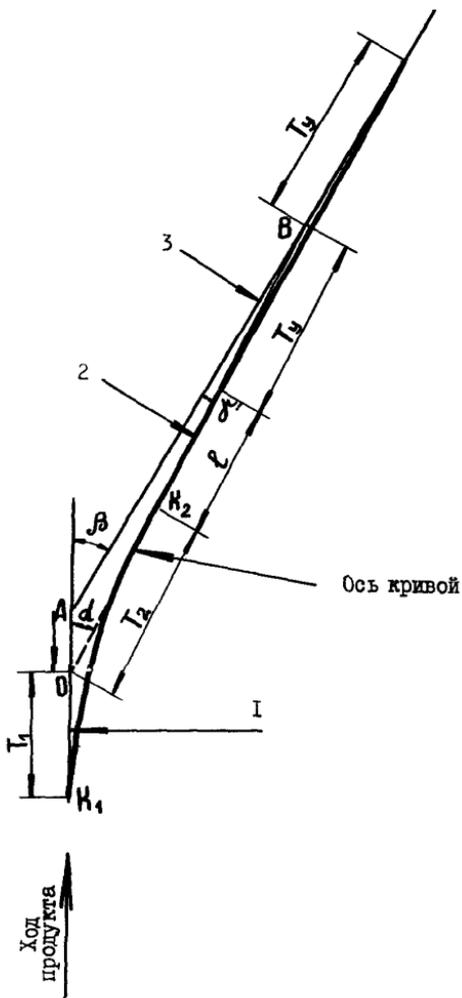
Рис.4. Перемещение вершины индивидуального угла назад (второй способ):
