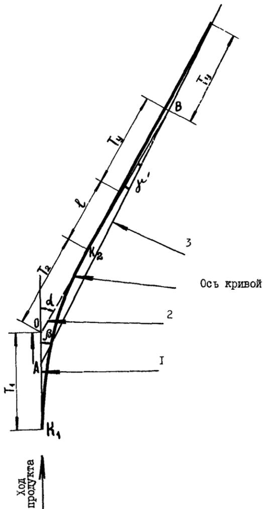
Рис.3. Перемещение вершины индивидуального угла вперед (второй способ):
