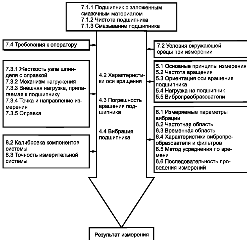
Рисунок 1 — Основные элементы измерения вибрации подшипника и факторы, влияющие на это измерение
