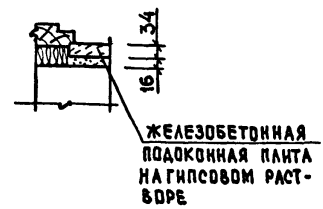
ФРАГМЕНТ УЗЛА 25 ПРИ УСТАНОВКЕ ЖЕЛЕЗОБЕТОННОЙ ПОДКОННОЙ ПАНТЫ
