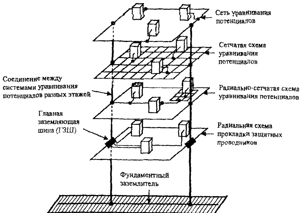
Рис. 16. Пример системы уравнивания потенциалов без присоединения молниезащиты
