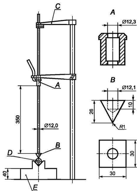
А — груз; В — закаленный стальной резец; С — фиксирующий кронштейн; D — образец; E — основание массой 10 кг
