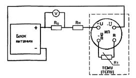
$B\Pi$  — источник питания постоянного тока 24 B;V — вольтметр;  $R_0$  - образцовое сопротивление 100 Ом;  $R_1$  — сопротивление нагрузки 250 Ом;  $U\Pi$  — измерительный преобразователь поверяемого термопреобразователя;  $R_1$  — платиновое сопротивление поверяемого термопреобразователя.
