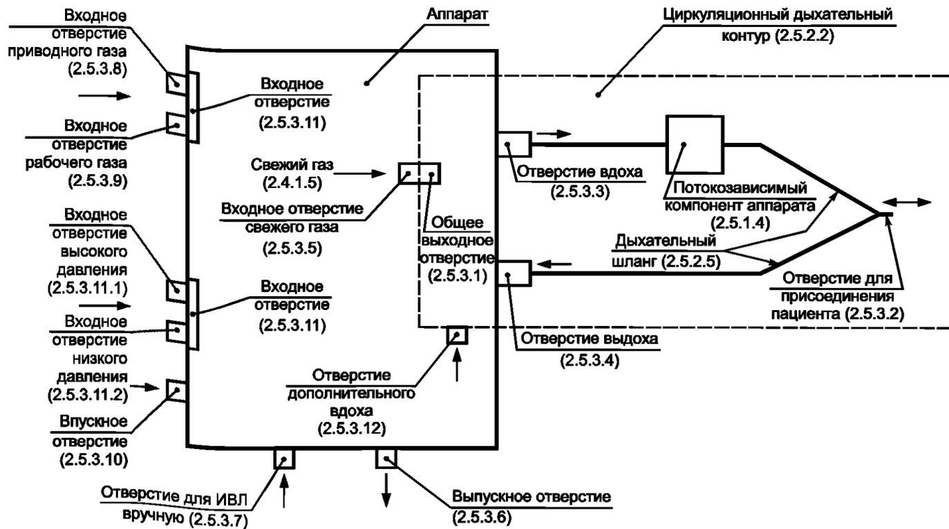
Рисунок А.1 — Схема расположения отверстий
