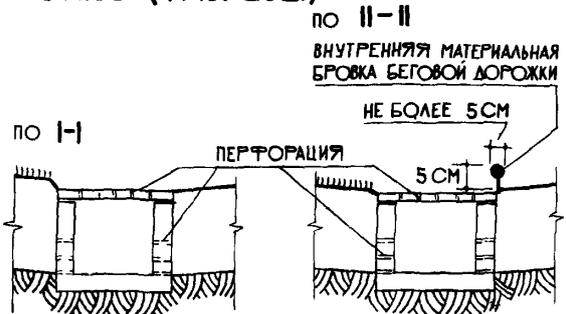
ВОДООТВОДНЫЕ ЛОТКИ, ПРЕДУСМАТРИВАЕМЫЕ ГЛАВНЫМ ОБРАЗОМ ДЛЯ ОТВОДА ПОВЕРХНОСТНЫХ ВОД И РАСПОЛАГАЕМЫЕ ЗА ПРЕДЕЛАМИ СООРУЖЕНИЯ, МОГУТ, В ЗАВИСИМОСТИ ОТ КЛАССА СООРУЖЕНИЯ И МЕСТНЫХ УСЛОВИЙ, ВЫПОЛНЯТЬСЯ КАК ЗАКРЫТЫМИ, ТАК И ОТКРЫТЫМИ (С УКЛОНОМ 0,003-0,005). ЛОТКИ СЛЕДУЕТ ВЫПОЛНЯТЬ ПОЛЫМИ (БЕЗ ЗАПОЛНЕНИЯ ДРЕНИРУЮЩИМ МАТЕРИАЛОМ).
