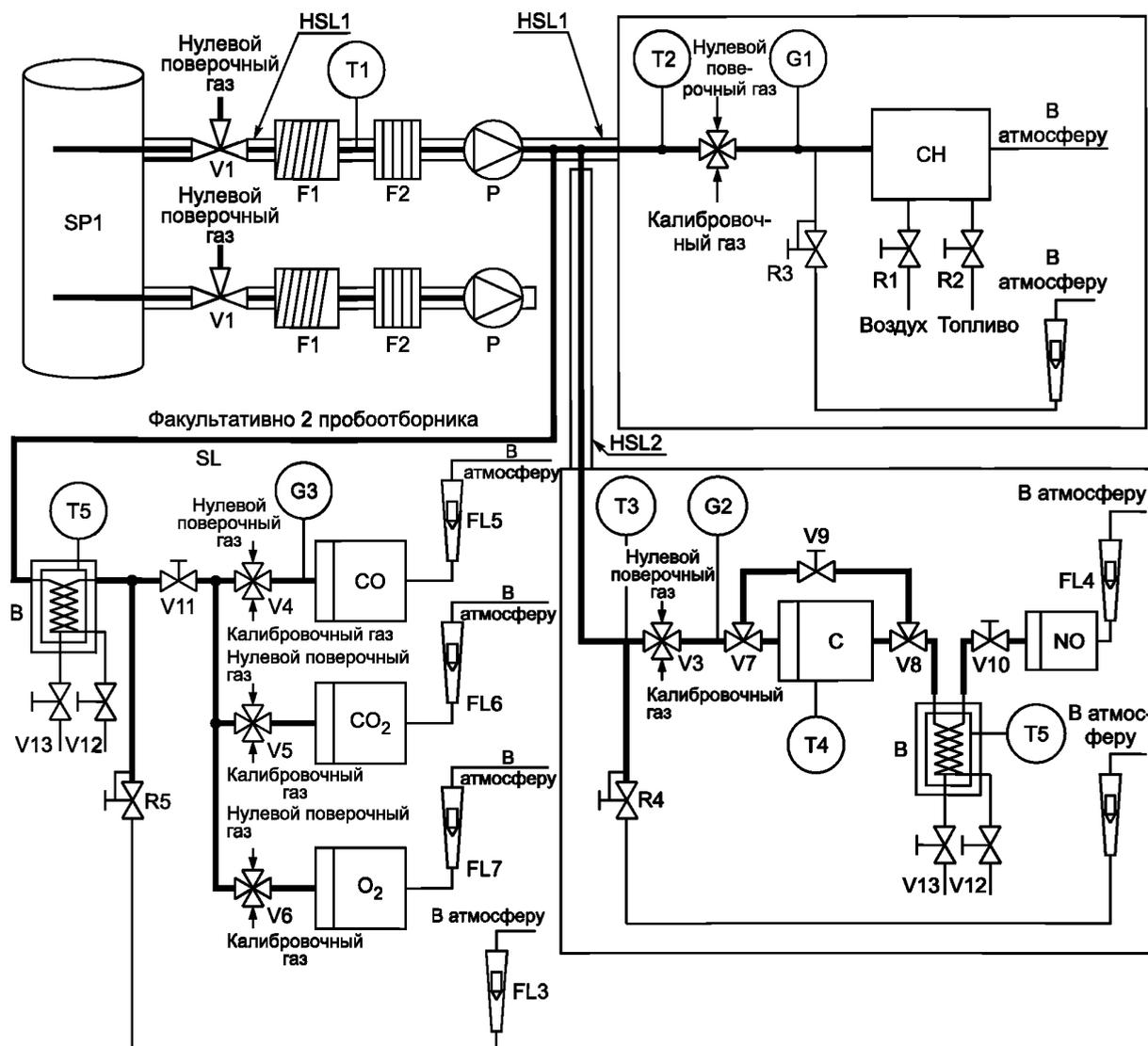
Рисунок Д.2 — Принципиальная схема установки для анализа отработавших газов с определением концентраций CO, CH и NO<sub>x</sub>
