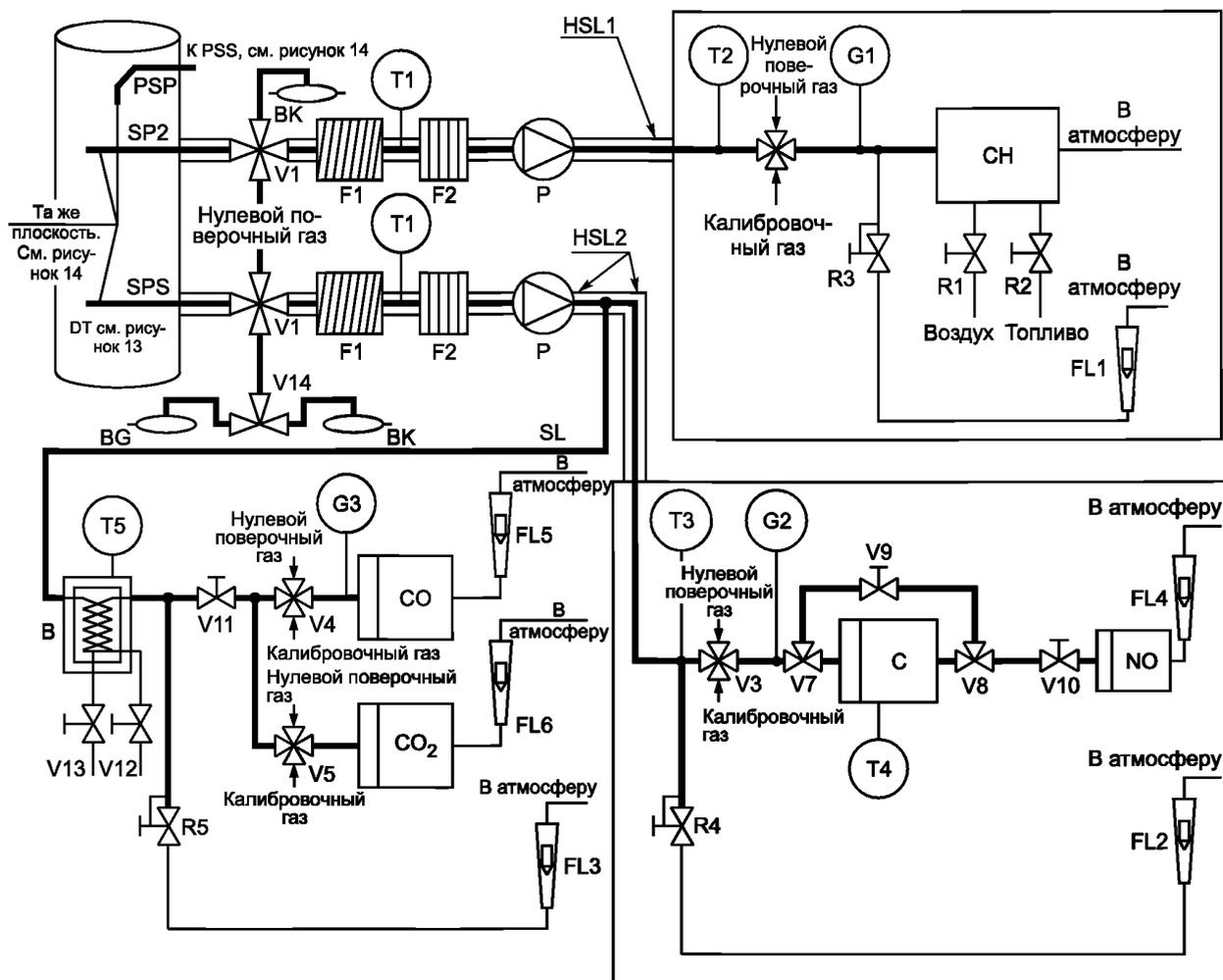
Рисунок Д.3 — Принципиальная схема установки для анализа разбавленных отработавших газов с определением концентраций CO, CO<sub>2</sub>, CH и NO<sub>x</sub>
