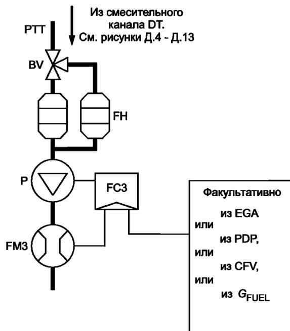
Рисунок Д.14 — Система отбора проб вредных частиц
